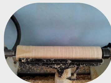
Обтачиваем, соблюдая правила безопасной работы на токарном станке, до круглого сечения и размечаем при помощи карандаша и линейки будущее яйцо.
