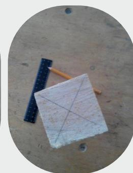
Производим на нём разметку и устанавливаем в токарный станок.
