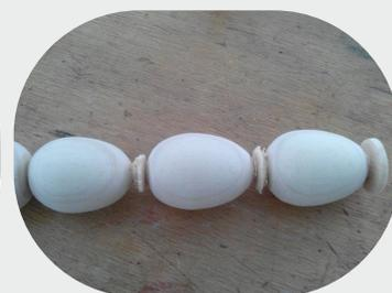
Размечаем на этой же заготовке ещё несколько яиц и вытачиваем. Шлифуем наждачной бумагой. Снимаем со станка и распиливаем ножовкой.
